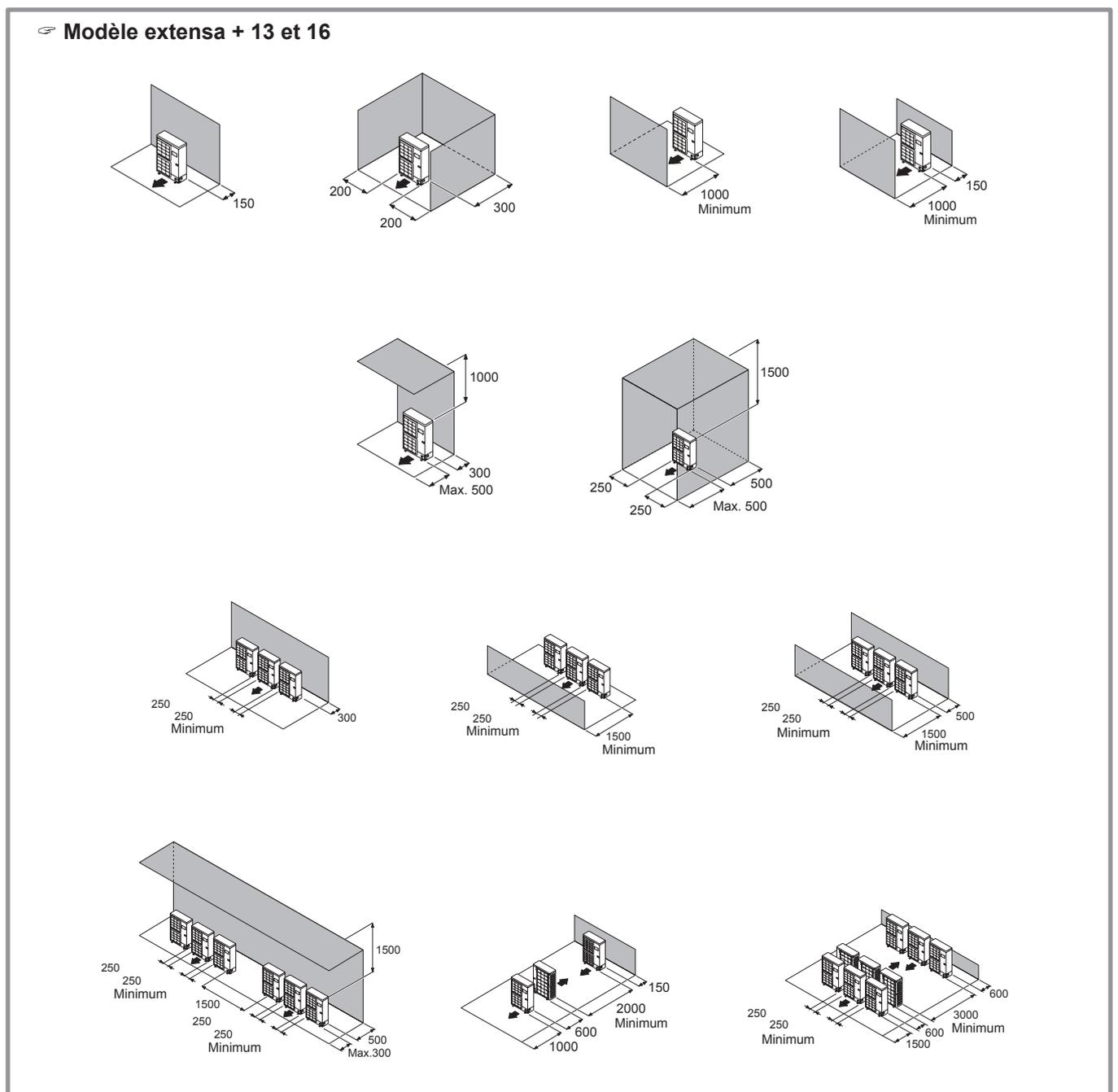
figure 15 - Dégagements minimum d'installation autour de l'unité extérieure (modèles extensa + 13 et 16)
