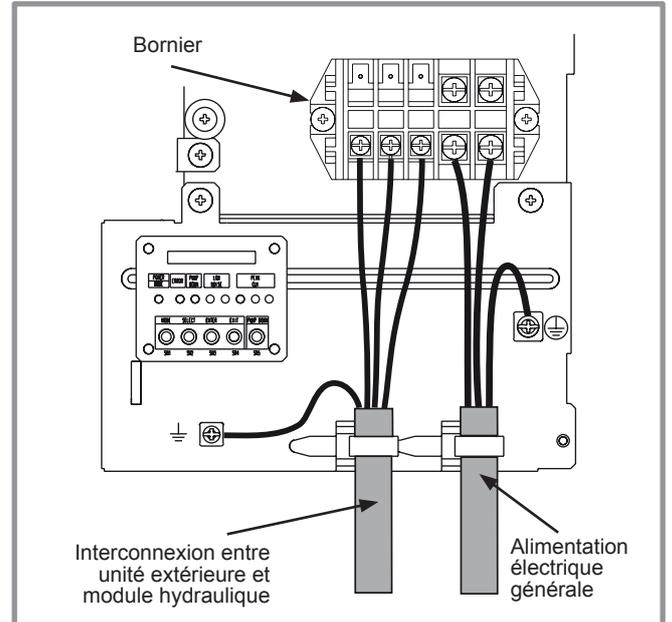
**figure 33 - Connexions au bornier de l'unité extérieure modèle extensa + 13 et 16**
