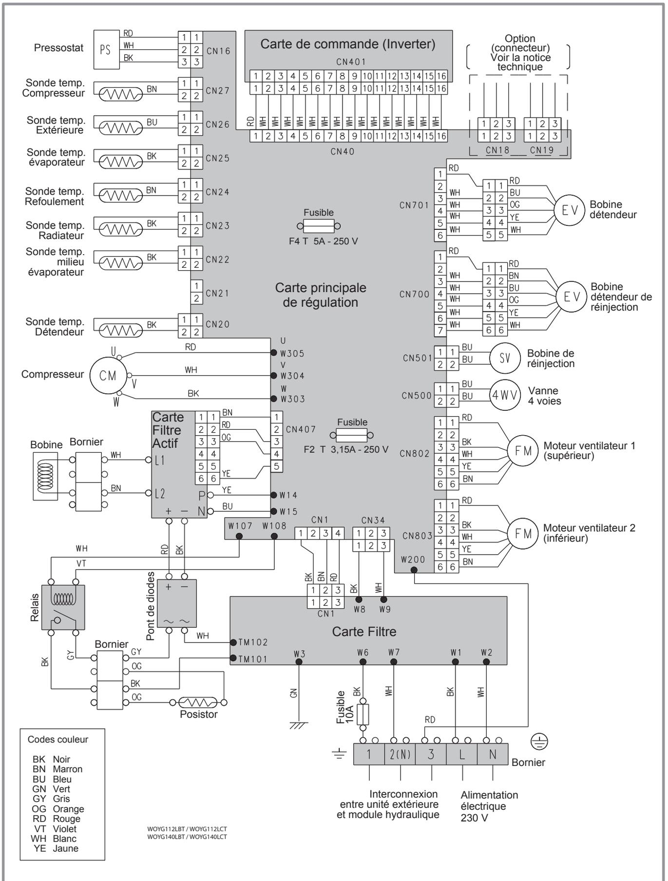
figure 47 - Câblage électrique unité extérieure modèle extensa + 13 et 16
