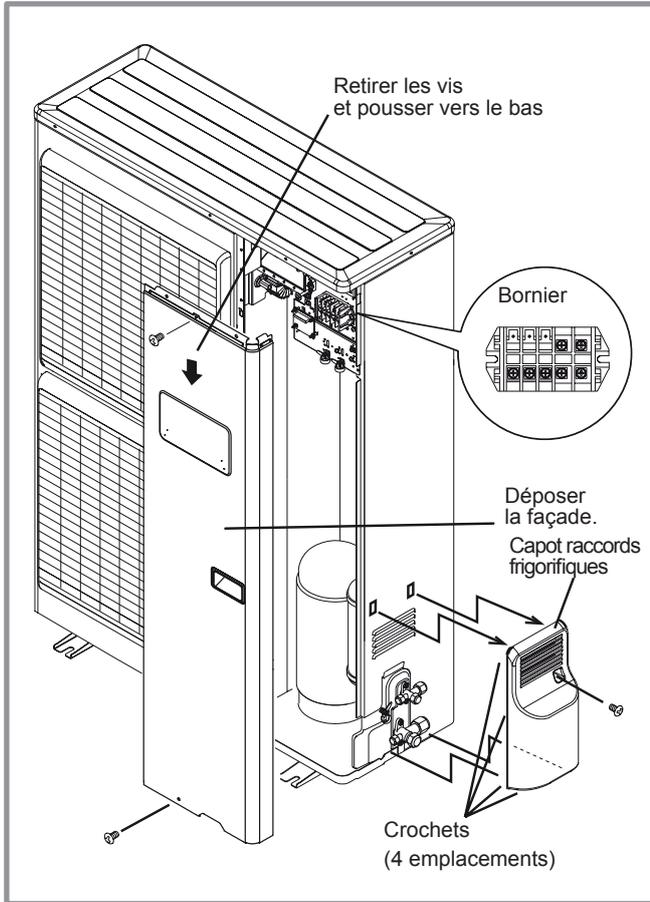
**figure 32 - Accès au bornier de l'unité extérieure modèle extensa + 13 et 16**
