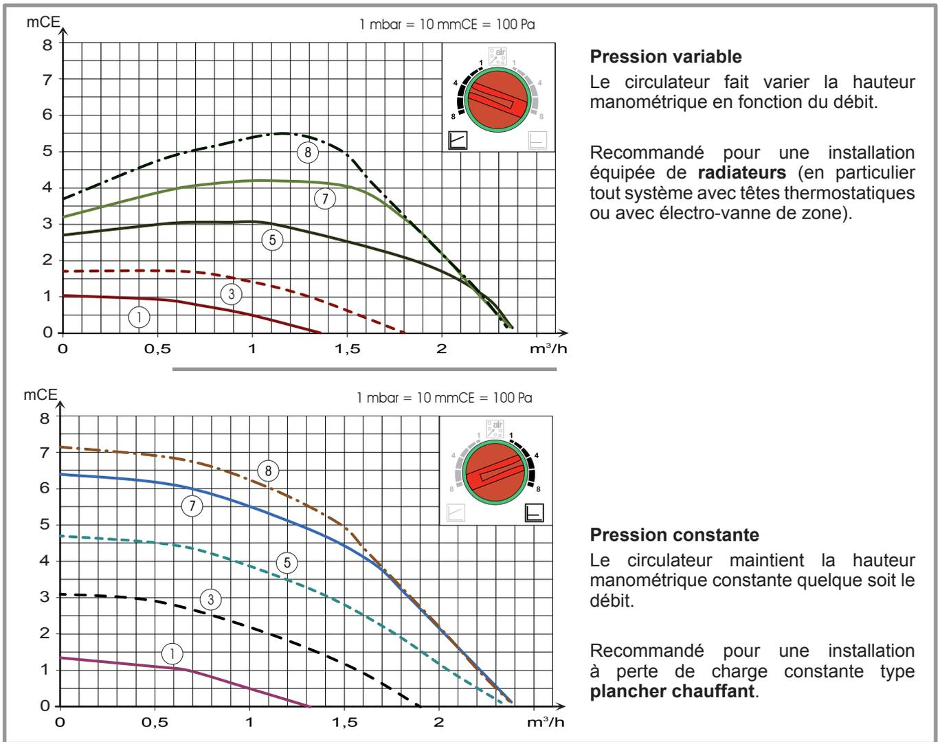
figure 26 - Pressions et débits hydrauliques disponibles (modèles extensa + 13 et 16)
