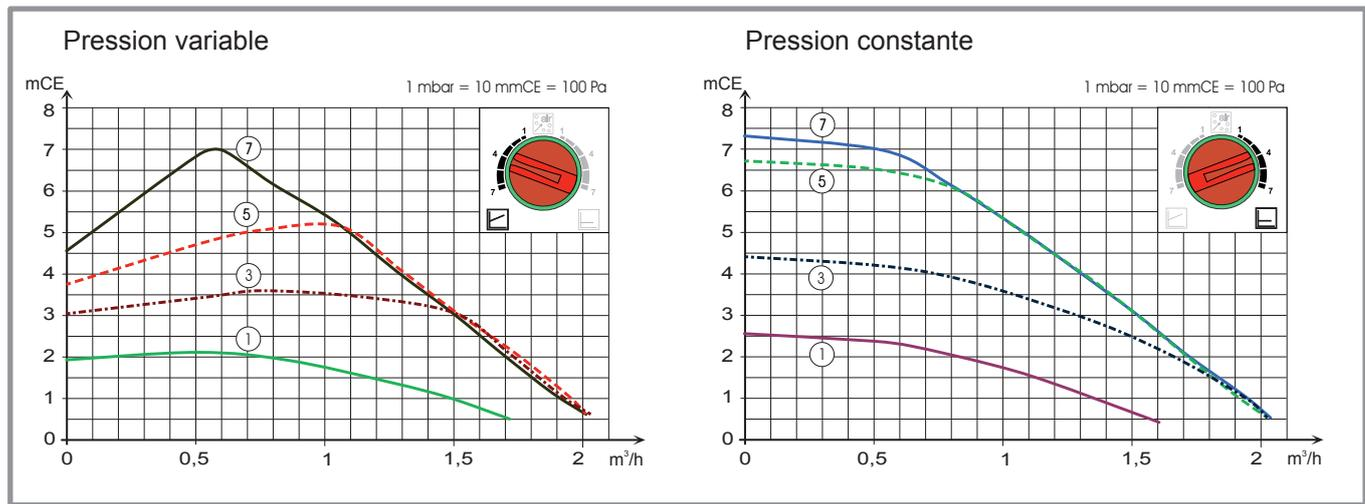
figure 5 - Pressions et débits hydrauliques disponibles (modèles extensa + 5, 6, 8 et 10)
