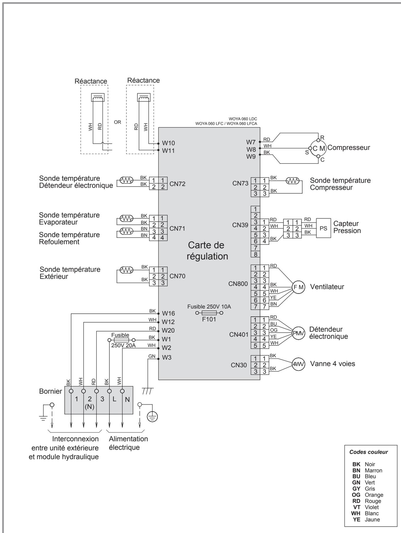
figure 44 - Câblage électrique unité extérieure modèle extensa + 5 et 6
