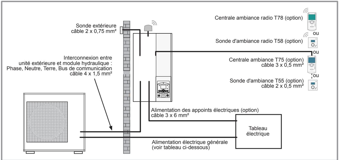
figure 29 - Schéma d'ensemble des raccordements électriques pour une installation simple (1 circuit de chauffe)
