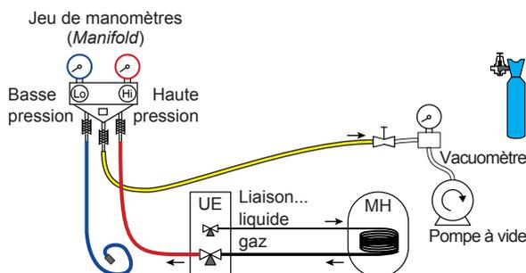
b) Couper la pompe à vide, fermer la vanne en bout du flexible de service (jaune), raccorder ce flexible sur le détendeur de la bouteille d'azote, injecter 2 bars, refermer la vanne du flexible,
