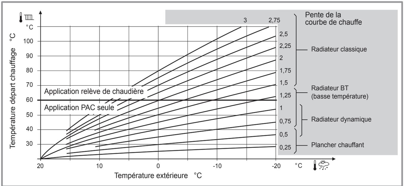
figure 41 - Pente de la courbe de chauffe (ligne 720)
