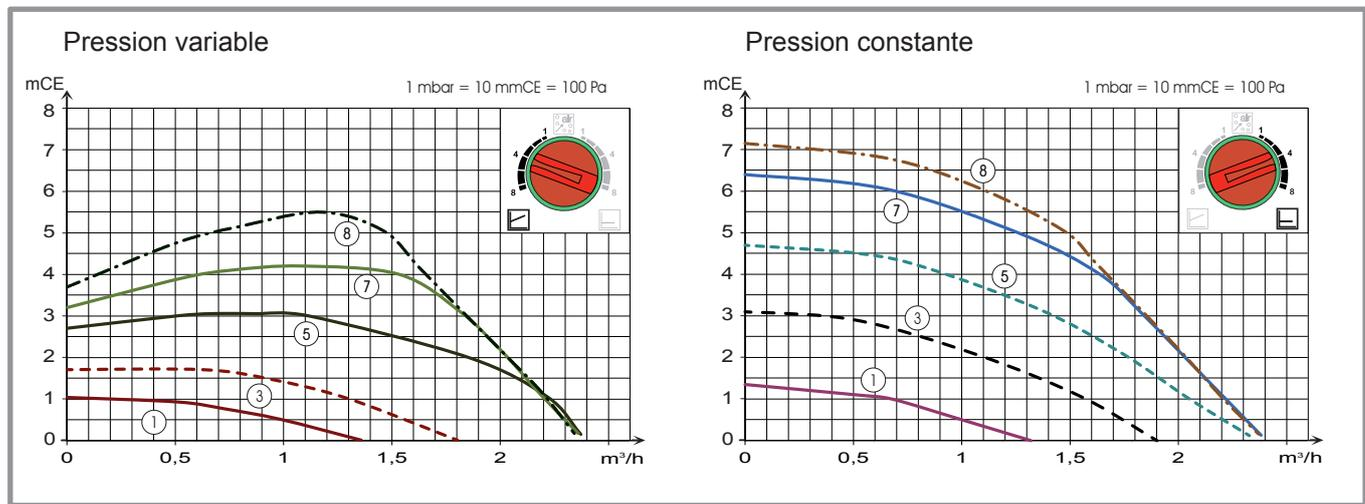
figure 7 - Pressions et débits hydrauliques disponibles (modèles extensa + 13 et 16)
