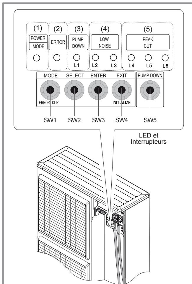
figure 49 - Emplacement des interrupteurs et LED de l'unité extérieure modèles extensa + 13 et 16
