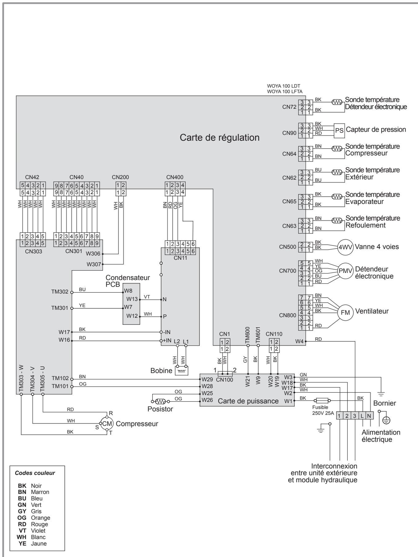
figure 46 - Câblage électrique unité extérieure modèle extensa + 10
