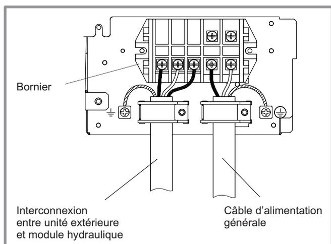
figure 30 - Connexions au bornier de l'unité extérieure modèle extensa + 5, 6, 8 et 10
