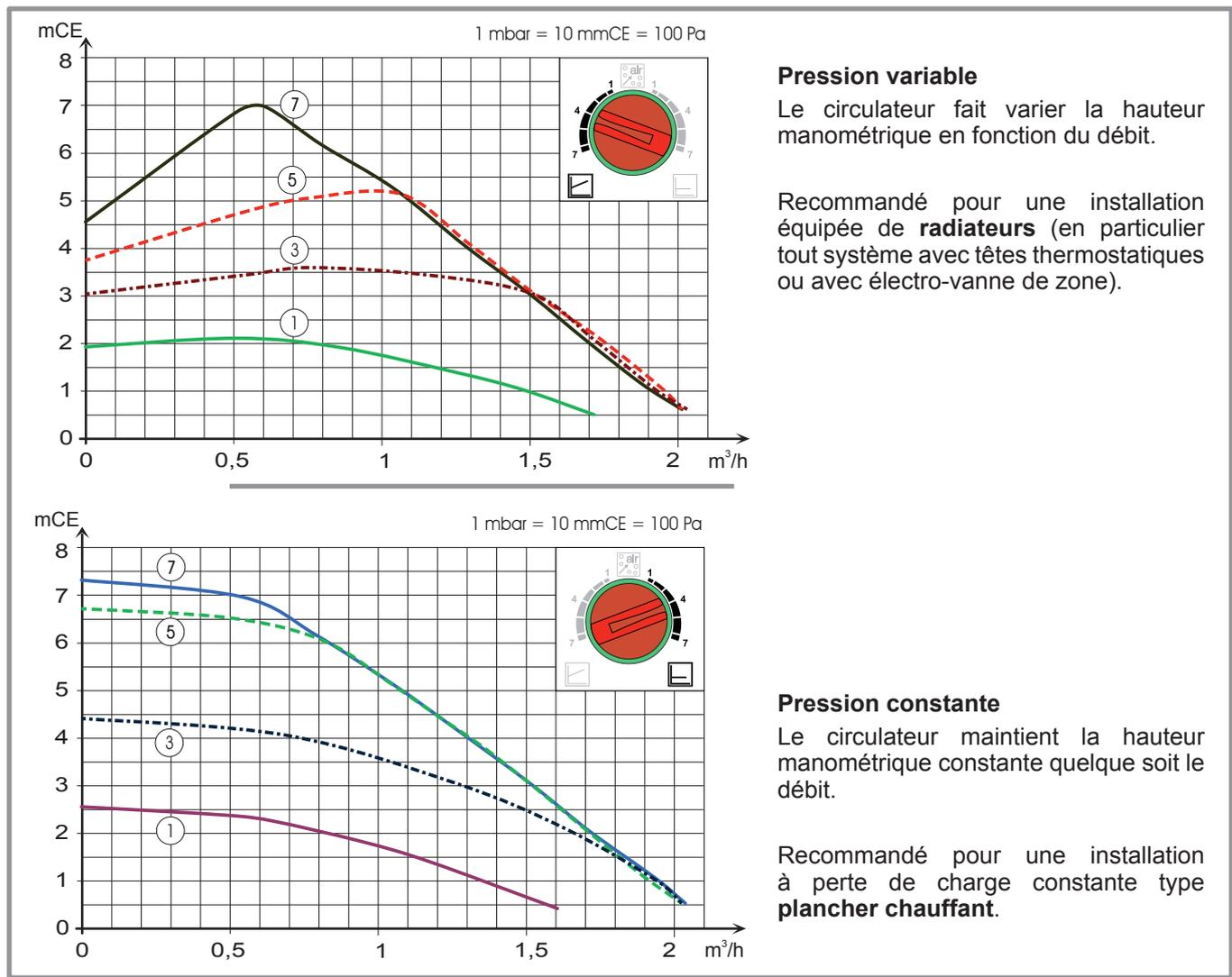
figure 25 - Pressions et débits hydrauliques disponibles (modèles extensa + 5, 6, 8 et 10)
