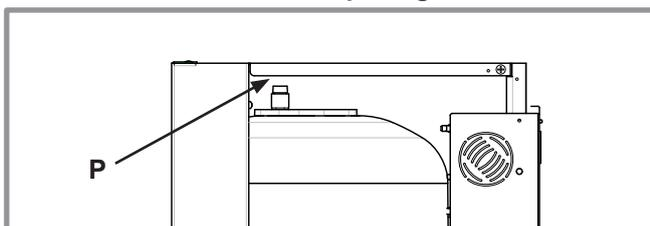
figure 24 - Purgeur manuel du module hydraulique
