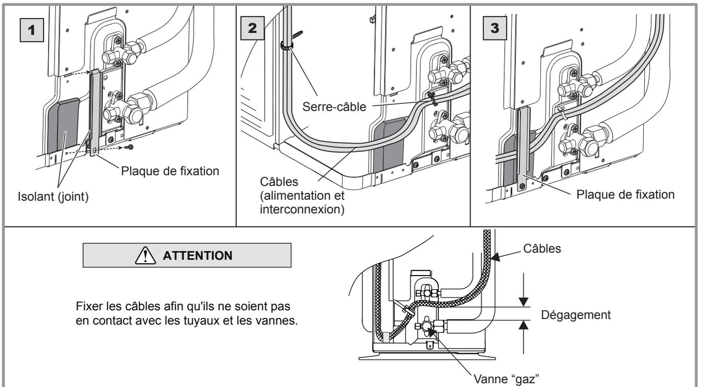
**figure 34 - Finalisation de la connexion de l'unité extérieure modèle extensa + 13 et 16**
