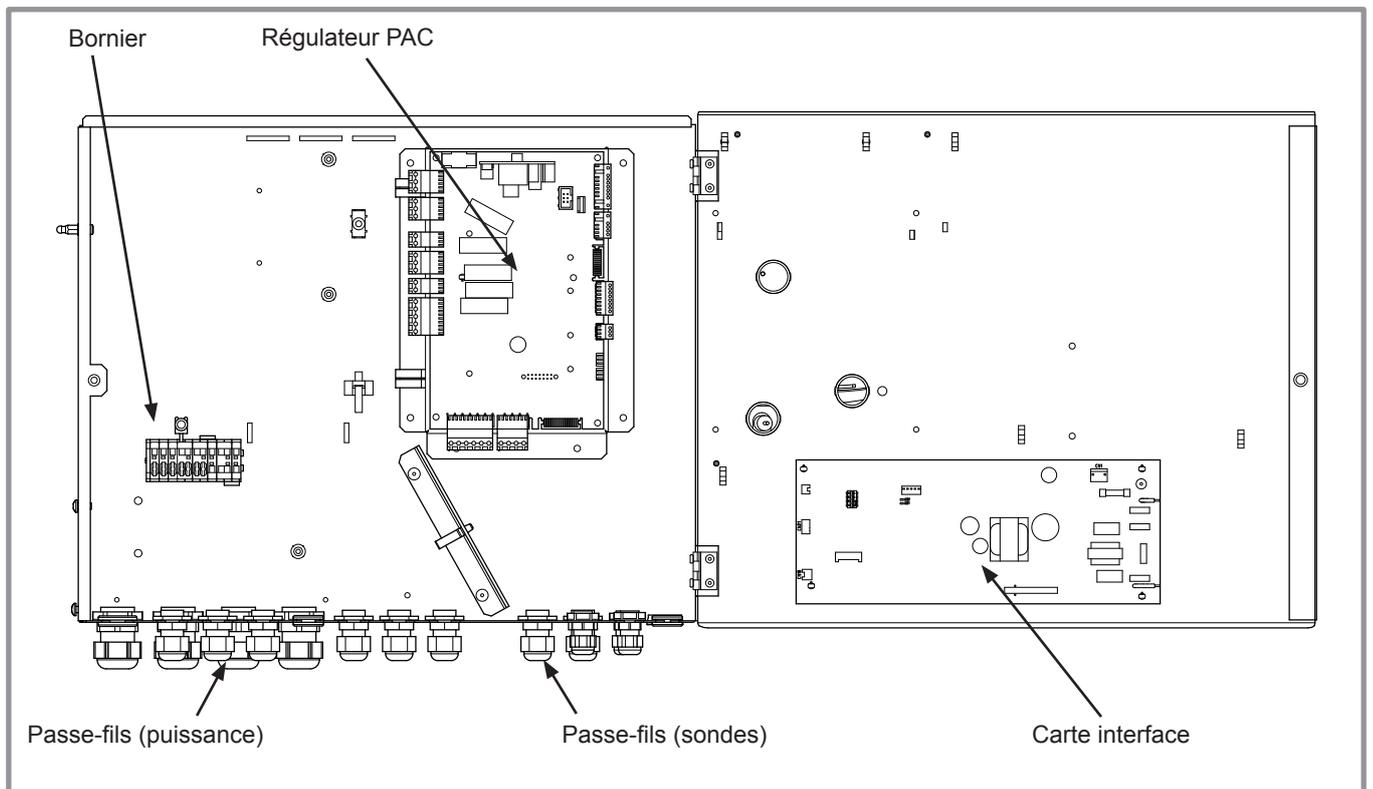
*figure 35 - Descriptif du coffret électrique du module hydraulique*
