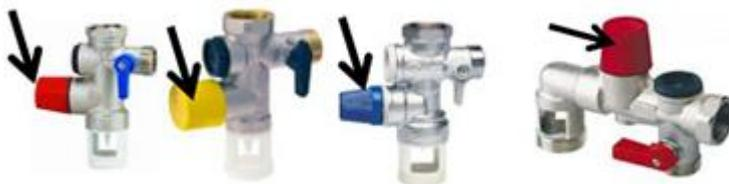
La vidange s'opère lentement ? Dévissez légèrement l'écrou de la sortie d'eau chaude sur le piquage eau chaude (collerette rouge). Ceci créera un appel d'air qui facilitera la vidange complète du ballon. Laissez le réservoir se vider complètement. L'opération peut prendre plusieurs minutes, voire plus d'une heure si votre **chauffe-eau électrique** à un taux d'entartrage élevé.
